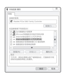
选择"自动获得IP地址"和"自动 获得DNS服务器地址"。点击"确 定"。返回上一个界面,点击"确 定"。
